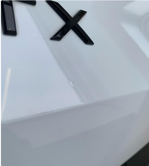
1.2 Liten steinsprut med korrosjon.
