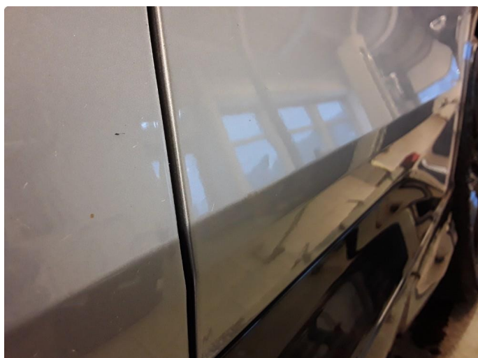
1.3 Liten steinsprut med korrosjon.
