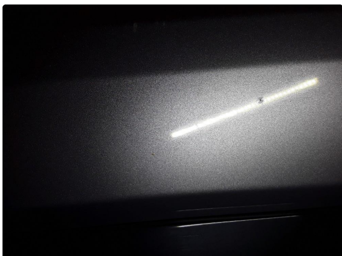
1.3 Liten steinsprut med korrosjon.
