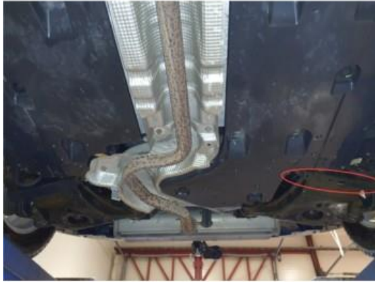
5.1 Øvrige feil Mangler deksel over bæream.
