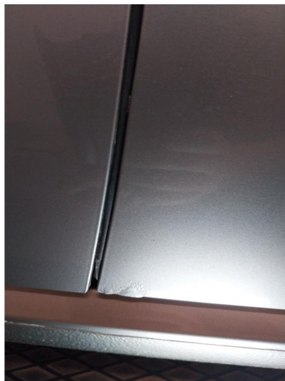
1.5 Steinsprut med rust
