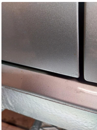
1.8 Steinsprut med rust
