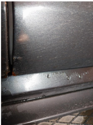
1.5 Steinsprut med rust
