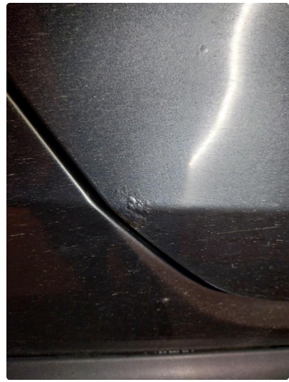
1.4 Steinsprut med rust
