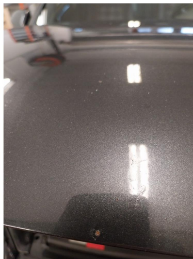
1.1 Noe steinsprut med rust
