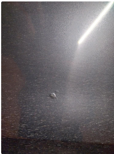
1.4 Steinsprut med rust
