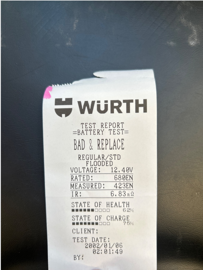
5.2 Batteritest «bad and replace»
