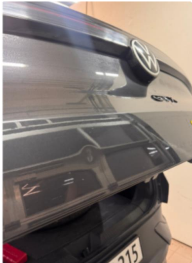
1.3 Liten bulk. Blir forsøkt med bulkfix. Liten steinsprut med korrosjon.
