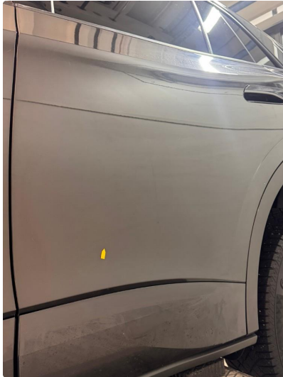
1.2 Liten steinsprut med korrosjon.
