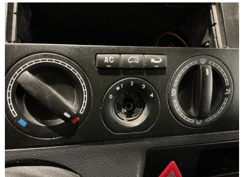
R 60. Varmeapparat / klimaanlegg (AC).
