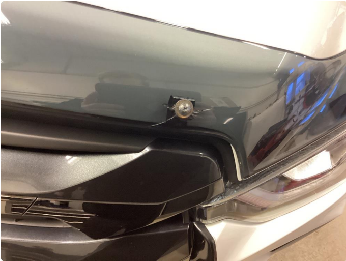
1.1 Sprekker i panserbeskyttelse ved alle skruer
