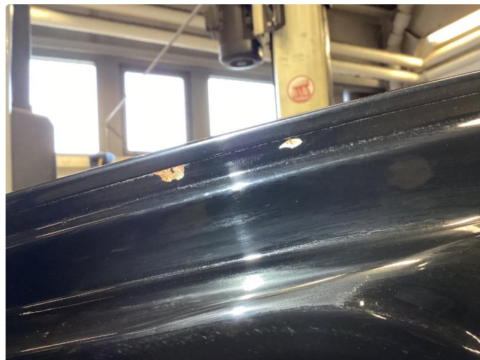
2.3 Rust i fals
