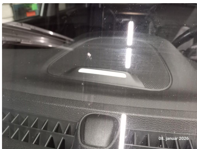
2.4 Steinsprut. Utbedret (limt)
