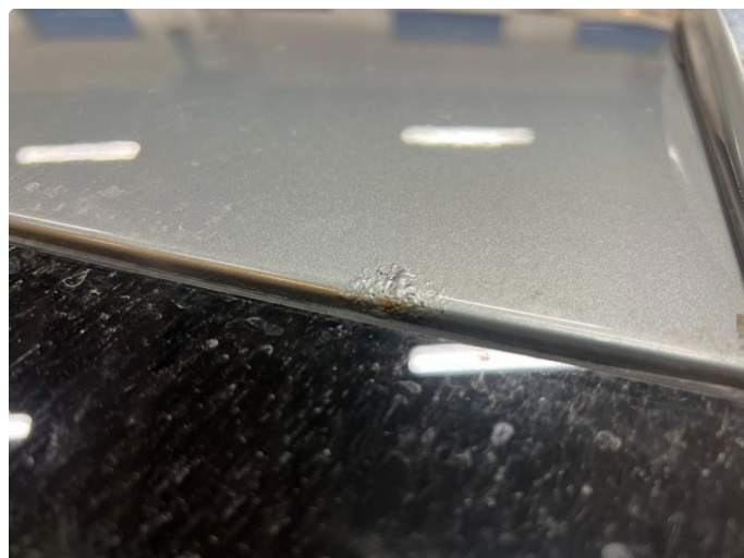
1.3 Steinsprut med rust
