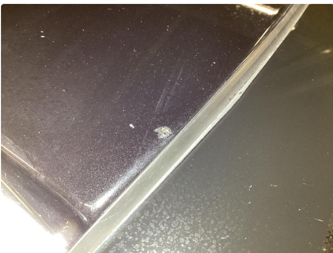
1.6 Steinsprut med rust
