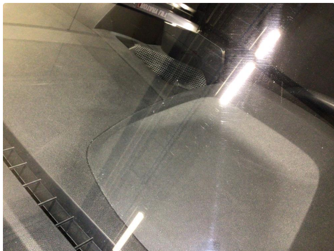
1.3 Noe slitasjeriper og steinsprut på frontvindu
