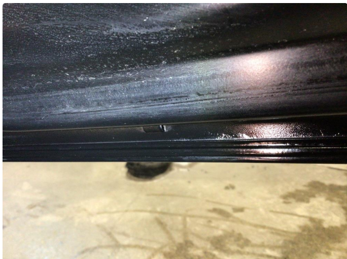
1.1 Litt korrosjon i fals ved venstre framdør, høyre skyvedør og høyre bakdør, dette er av ubetydelig karakter
