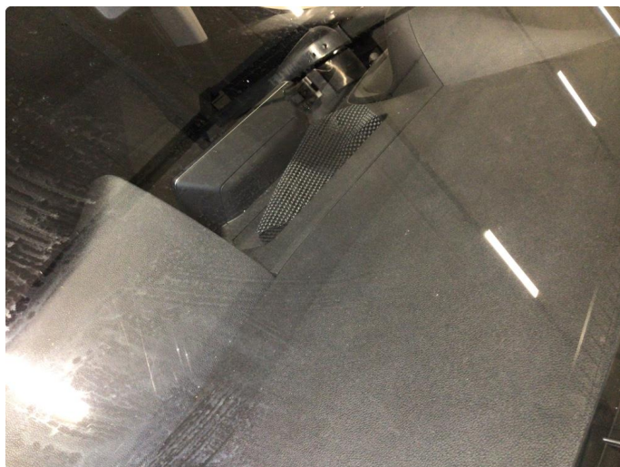
1.3 Noe slitasjeriper og steinsprut på frontvindu
