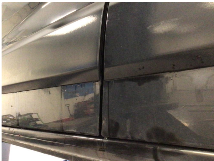
1.2 Liten bulk i nedre kant av venstre skyvedør, dette blir utbedret
