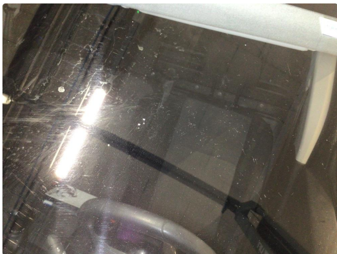
1.3 Noe slitasjeriper og steinsprut på frontvindu
