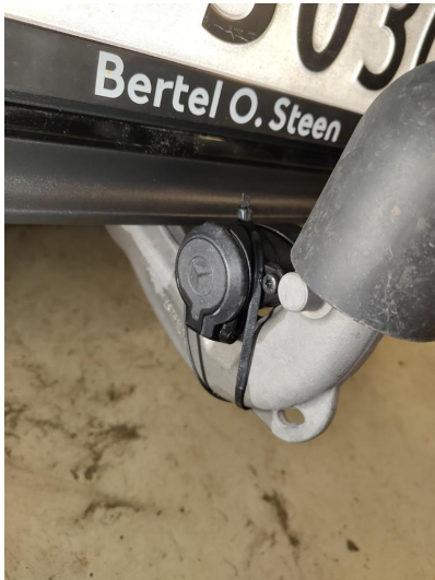
1.2 Tilhengerkontakt- innfesting skadet / Stripset
