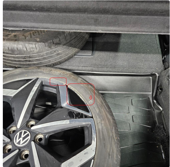
1.1 Skrubber/riper på en sommerfelg (flenge på dekkside er kun kosmetisk - stålcord er ikke synlig - OK)
