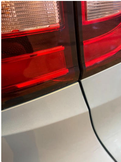
2.1 Krakelering i plast, blir byttet før salg
