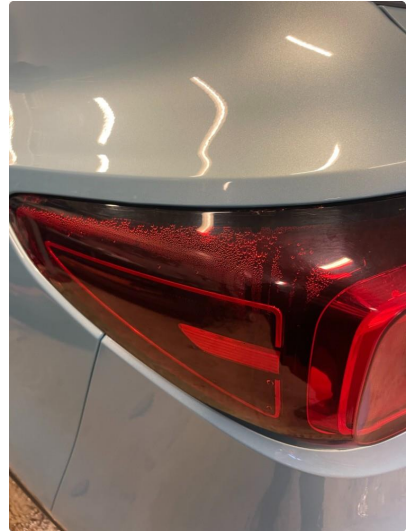
2.1 Krakelering i plast, blir byttet før salg
