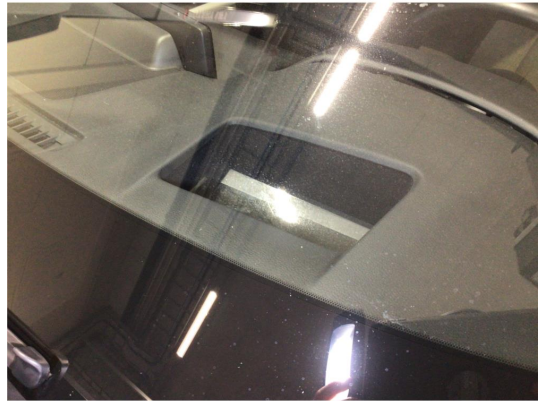
1.2 Noe steinsprut på frontvindu
