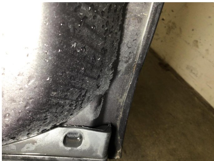
1.3 Noe korrosjon i fals på dører
