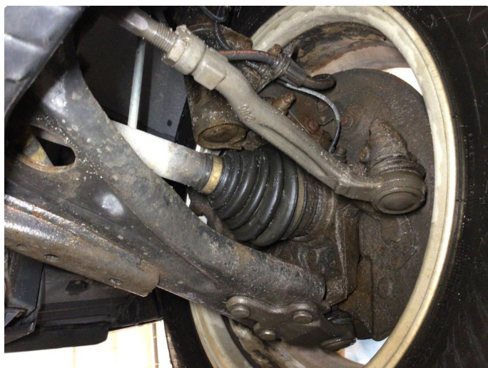
2.1 Noe overflaterust i forstilling, ingen tiltak kreves
