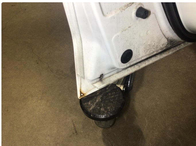
1.1 Litt korrosjon i nedre del av venstre framdør
