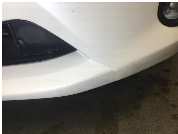
1.3 Liten sprekk i nedre del av frontfanger venstre side blir utbedret
