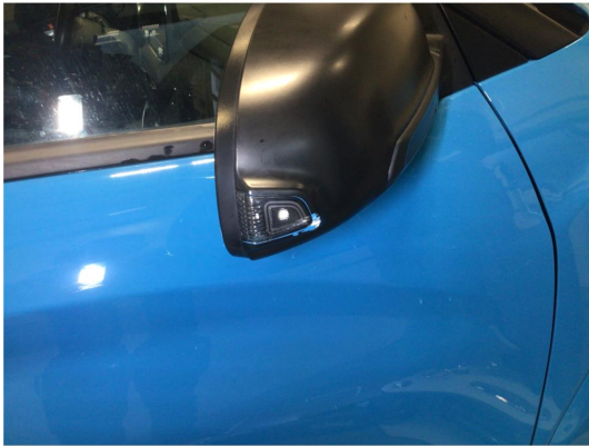
1.1 Ripe på speilhus høyre side blir utbedret
