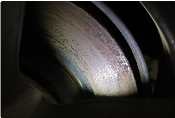
3.1 Noe rust på bremseskiver ( blir bedre ved kjøring/bremsing )
