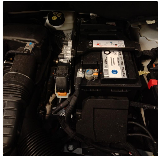
3.2 Deksel til pluss pol på 12v batteri er ikke montert
