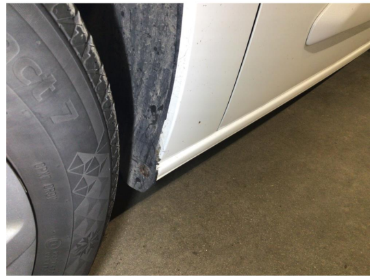
1.2 Noe korrosjon i nedre del av begge framskjermer, dette blir utbedret
