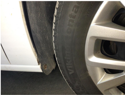
1.2 Noe korrosjon i nedre del av begge framskjermer, dette blir utbedret
