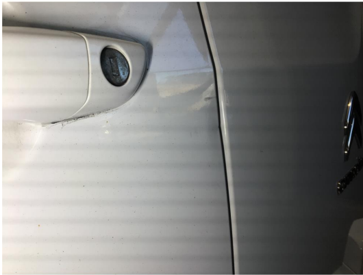
1.1 Liten bulk i nedre del av venstre skyvedør
