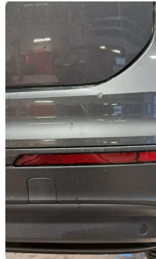
1.4 Skade på støtfangerkappe
