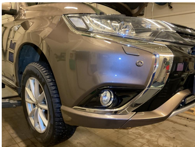
1.3 Noe små steinsprut og riper på støtfanger foran.
