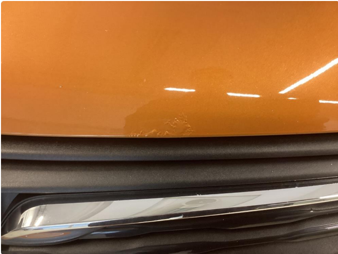
1.1 Rust i fals
