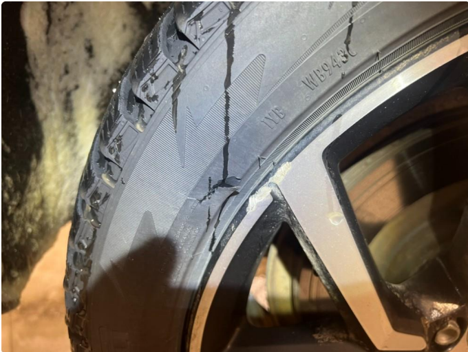
1.1 Kantkjørt felg høyre bak
