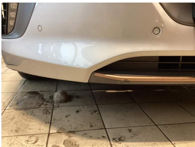
1.7 Skade/ sprekk i plast på frontfanger
