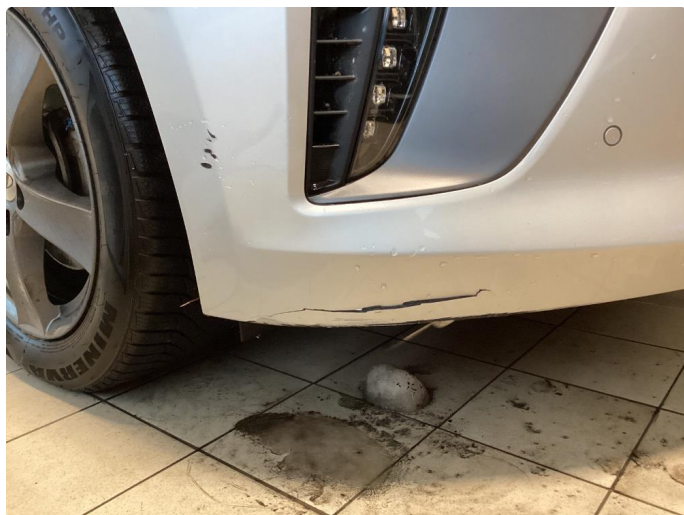
1.7 Skade/ sprekk i plast på frontfanger
