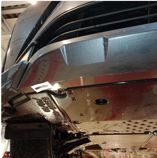
1.2 Skrubbskader underkant. SLITASJE VURDERES USYNLIG.
