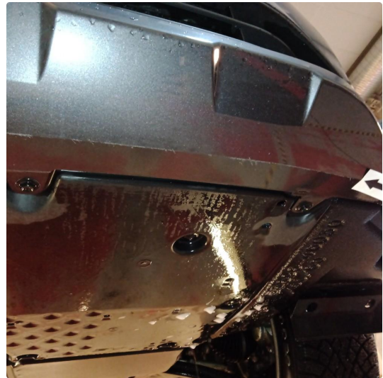
1.2 Skrubbskader underkant. SLITASJE VURDERES USYNLIG.
