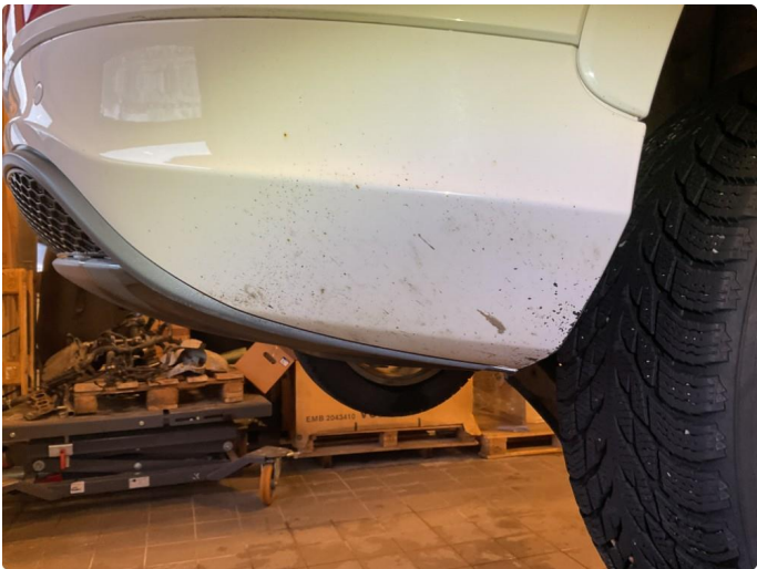
1.5 Noe merker på nede del støtfanger bak. Fremstår ikke sjenerende
