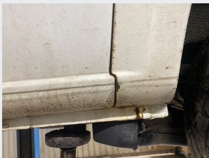
2.4 Set finnes rust på kanaler
