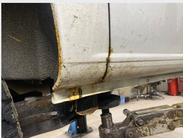
2.4 Set finnes rust på kanaler
