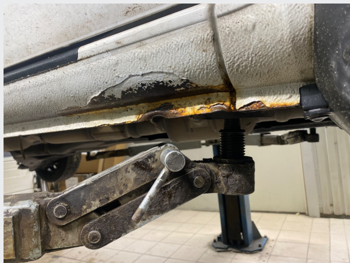
2.4 Set finnes rust på kanaler
