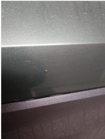
1.1 Steinsprut med korrosjon
