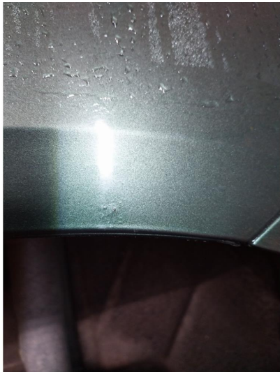
1.3 Steinsprut med Korrosjon
