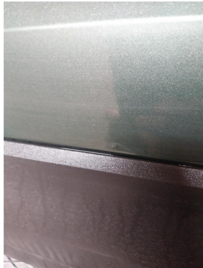
1.2 Steinsprut med Korrosjon
