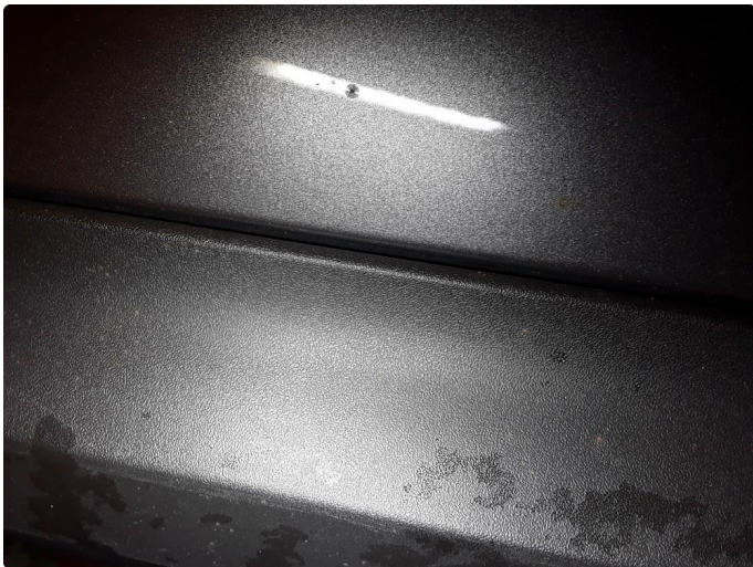
1.2 Liten steinsprut med korrosjon.
