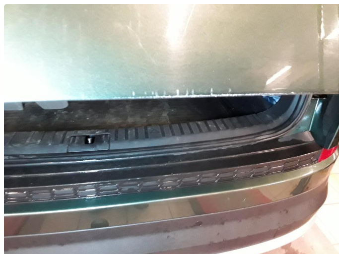
1.2 Noen riper nedre del og en liten steinsprut med korrosjon.
