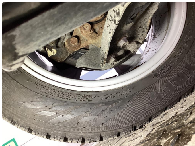
1.1 Rust. VURDERE Å SKIFTE BREMSER PGA RUST.
