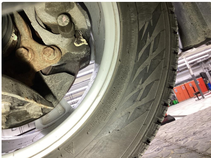
1.1 Rust. VURDERE Å SKIFTE BREMSER PGA RUST.
