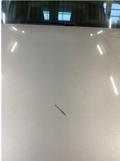
1.1 Korrosjon/sinkslipp (utbedret m/flekking)
