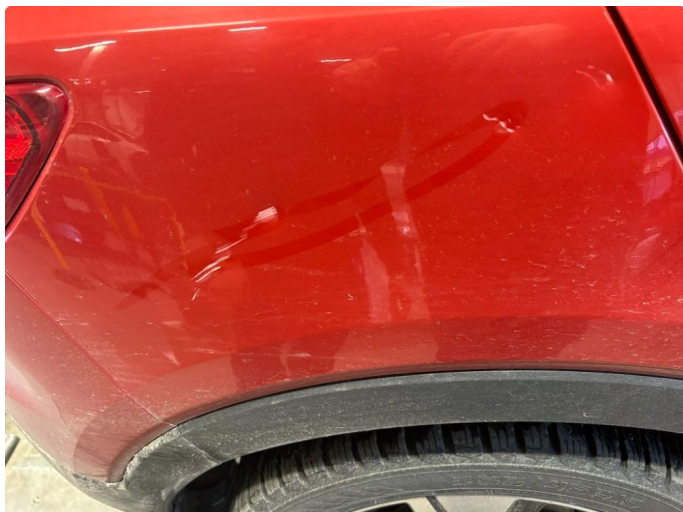
1.3 Bulk med lakkskade ( Forsikringssak)
