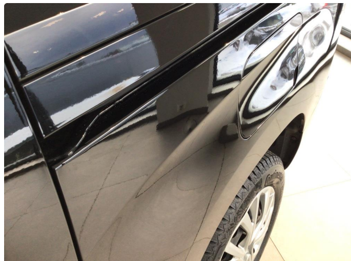
1.1 Noen små p-bulker rundt på bil, noen blir utbedret og andre anses som normal bruksslitasje
