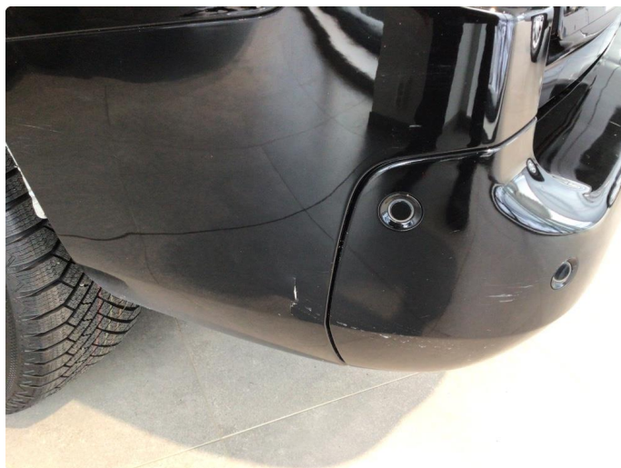
1.4 Liten sprekk venstre side, samt noe riper ved innlastingssone på bakfanger
