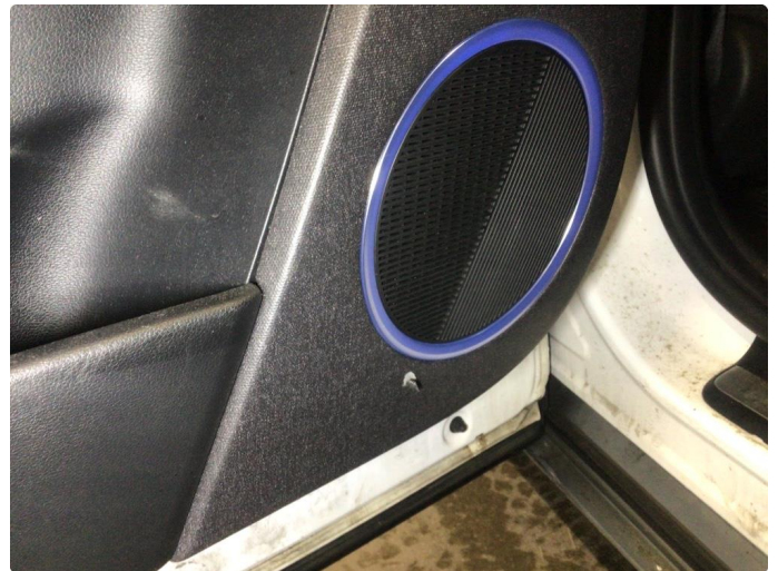
2.1 Liten rift i dørtrekk venstre side bak blir utbedret
