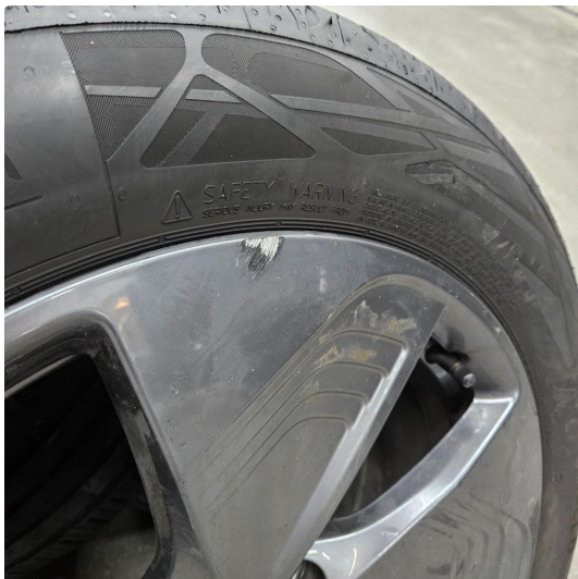
1.1 Skrubbermerker på sommer/vinter-felger
