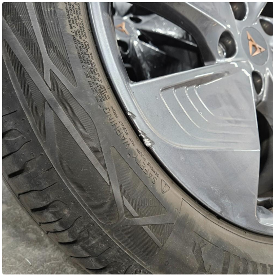
1.1 Skrubbermerker på sommer/vinter-felger
