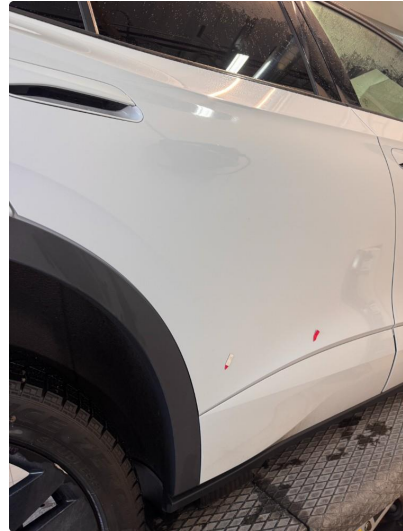
1.2 Liten steinsprut med korrosjon.
