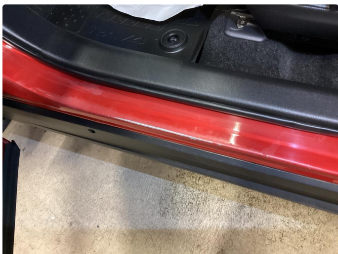
1.2 Slitasje dørterskel førerside
