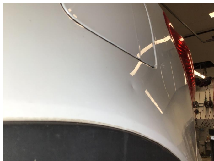
1.2 Noen bulker med lakkskader
