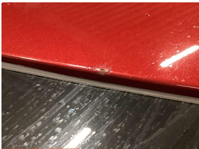
1.1 Endel steinsprut og småskader i lakk og frontrute på bil. Steinsprut med rust over frontrute
