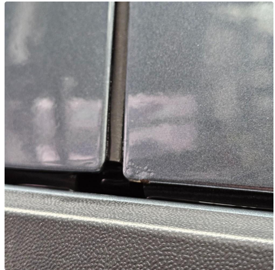
1.1 Noe antydning til korrosjon
