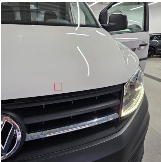
1.1 Små lakkskader på panser
