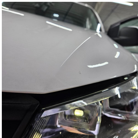
1.1 Små lakkskader på panser
