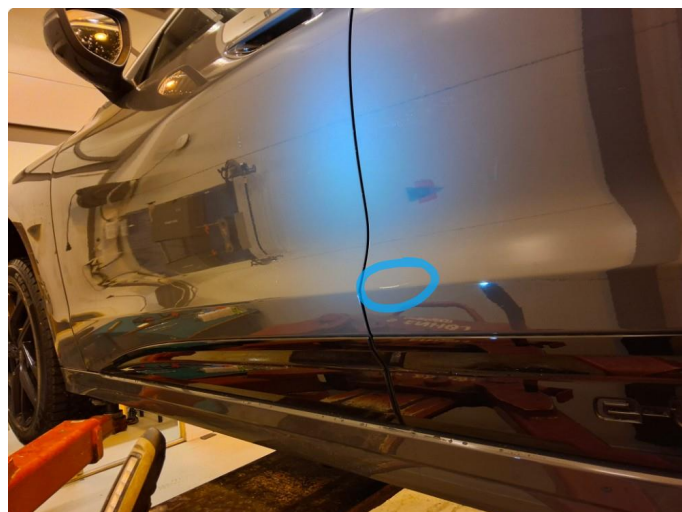
1.1 Ripe ned til grunning
