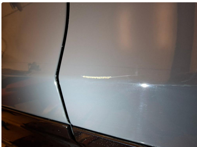
1.1 Ripe ned til grunning
