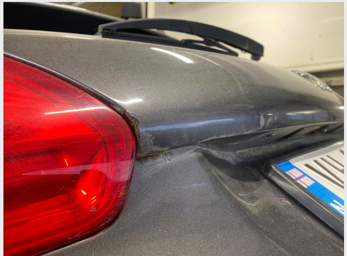
2.5 Påbegynnende rust bakluke
