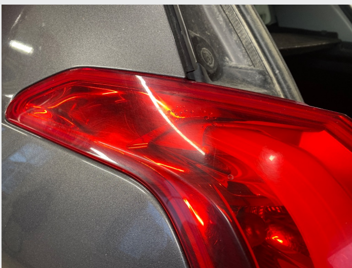
3.2 Fukt i lykt venstre bak
