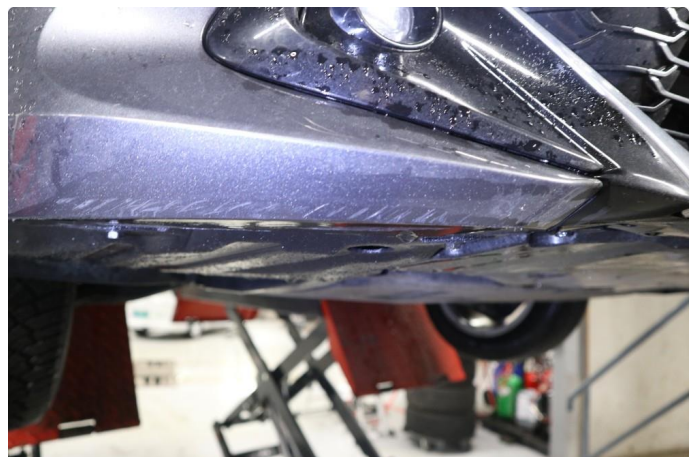
1.3 Skrubbskader underkant høyre side
